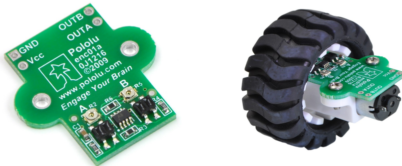
Figura 1. Sensor de rotación óptico, colocado en un motor de corriente directa con llanta.
