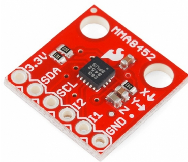
Figura 1: Circuito MMA8452Q alambrado en un PCB.
