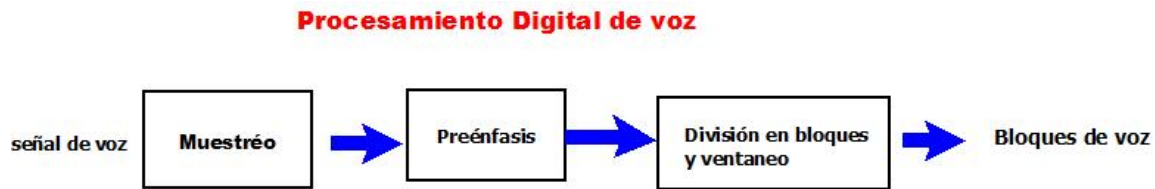
Figura 5.2: Diagrama de bloques del procesamiento digital
