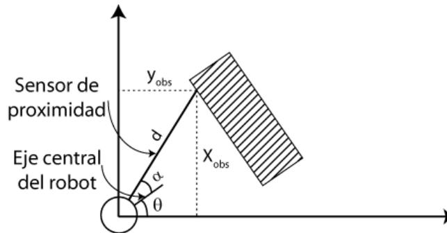
Donde  $d$  es la distancia reportada por el sensor al obstáculo, el sensor está localizado con un ángulo  $\alpha$  con respecto al centro del robot. Entonces la posición del obstáculo con respecto al centro del robot:
