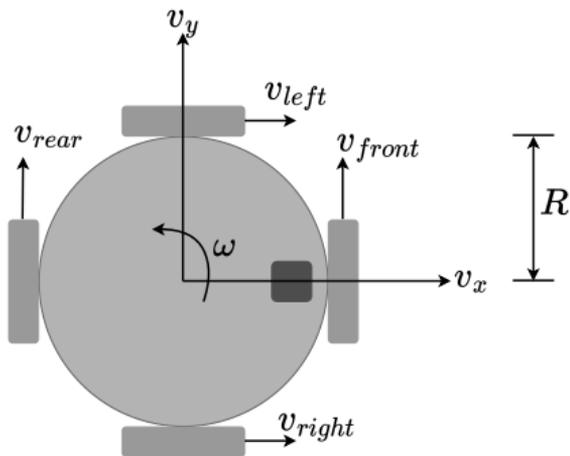
$$\begin{bmatrix} v_{left} \\ v_{right} \\ v_{front} \\ v_{rear} \end{bmatrix} = \begin{bmatrix} 1 & 0 & -R \\ 1 & 0 & +R \\ 0 & 1 & +R \\ 0 & 1 & -R \end{bmatrix} \begin{bmatrix} v_x \\ v_y \\ \omega \end{bmatrix}$$
