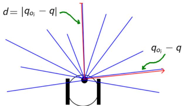
Las lecturas del lidar generalmente son pares distancia-ángulo  $(d_i, \theta_i)$  expresados con respecto al robot, por lo que, si se conoce la posición del robot  $(x_r, y_r, \theta_r)$ , la posición de cada obstáculo se puede calcular como:
