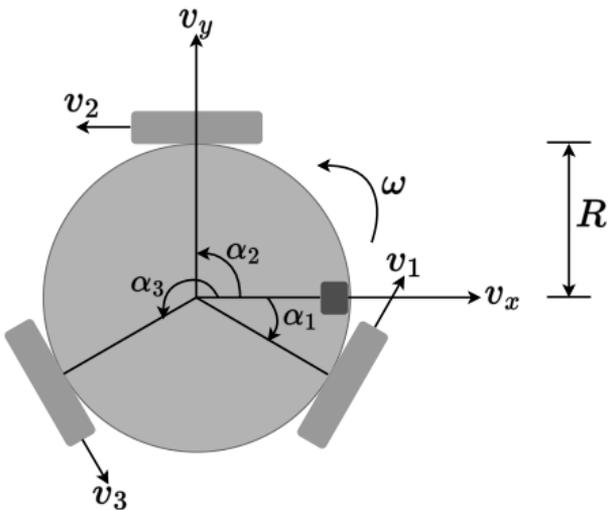
$$\begin{bmatrix} v_1 \\ v_2 \\ v_3 \end{bmatrix} = \begin{bmatrix} -\sin \alpha_1 & \cos \alpha_1 & R \\ -\sin \alpha_2 & \cos \alpha_2 & R \\ -\sin \alpha_3 & \cos \alpha_3 & R \end{bmatrix} \begin{bmatrix} v_x \\ v_y \\ \omega \end{bmatrix}$$
