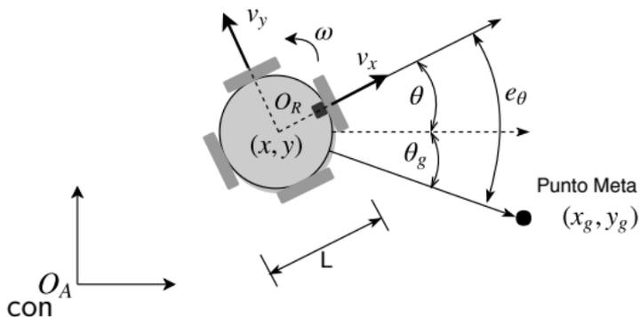
Considere una base diferencial y el punto meta  $(x_g, y_g)$ , las siguientes leyes de control permiten al robot alcanzar dicho punto meta:
