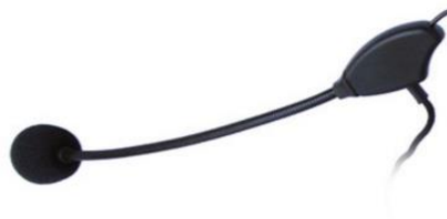
Fig 4.5 Micrófono de condensador, muy común en los auriculares comerciales.
